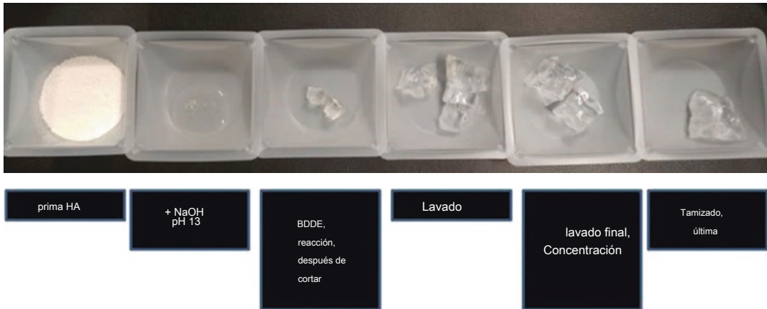
Fig. 2.5 cambio de relleno de ácido hialurónico durante el proceso de fabricación
